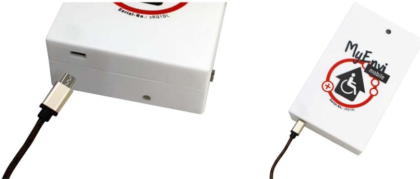
3. Wenn an den MyEnvi Server ein Mikrofon angeschlossen werden soll, dann öffnen Sie bitte die Abdeckung auf der Rückseite und nutzen den USB-Anschluss im Inneren (siehe Foto)
